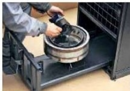
Чаша горения выдвинута для обслуживания. Удобно устроено! Готовим ее к розжигу – наливаем порцию солирки.
